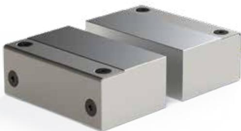
当社の浮き上がり防止ジョーは、クリートと角度の付いた柔らかいジョーを使用しており、送りネジにトルクが加えられたときにジョーを引き下げます。この設計により、セルフセンタリングバイスで一般的に見られるジョーの浮き上がりとたわみが減少します。
